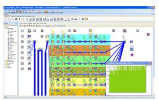
Die in *Plant Simulation* beinhalteten Analysewerkzeuge erlauben es Engpässe aufzudecken, oder überdimensionierte Ressourcen zu isolieren. So trägt *Plant Simulation* dazu bei, frühzeitig Probleme zu entdecken und aufzuzeigen, die ansonsten während der Anlaufphase einer Produktion kosten- und zeitaufwändige Korrekturmaßnahmen nach sich gezogen
