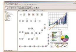
*Plant Simulation* erlaubt es, komplexe Materialflussregeln zu definieren und deren Auswirkungen auf die Leistung der Linie zu überprüfen.
